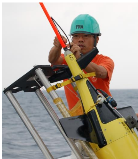
観測船の上で、水中グライダーという機械の準備をしているところ
